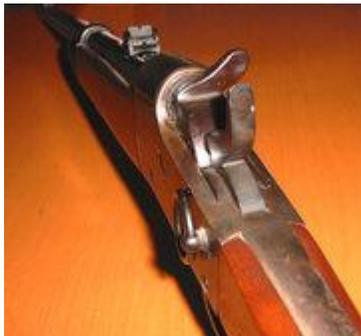
Rolling Block abgeschlagen und verriegelt
