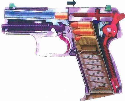
Verschluss im Rücklauf, Rohr entriegelt,
