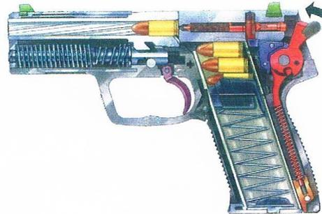
Patrone abgefeuert, Verschluss und Rohr im Rücklauf beim Entriegeln.
